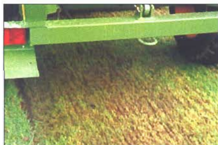
Coupe verticale (agrée) avec ramassage et insufflation directe.
