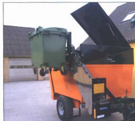
Wagon de ramassage de déchets. Volume: 6,0 m 3 . Hauteur au sommet: 2,30 m.
