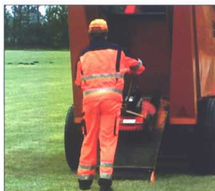
Rampe d'approche intégrée pour le transport des petites machines, des outils à main, des pieux, etc.
