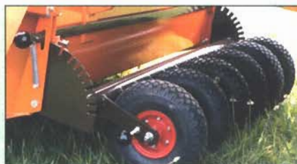
Roues remplies de mousse au lieu d'un rouleau arrière en acier.
