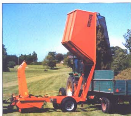
Déchargement de la benne. Volume: 3,5 m 3 . Hauteur au sommet: 2,25 m.
