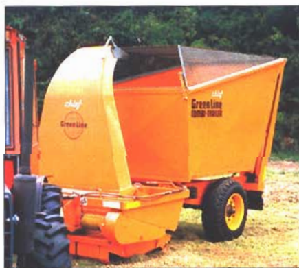
Combi-Trailer – Volume: 3,5 m 3 . Largeur de coupe: 1,30 m. Hauteur au sommet: 2,25 m.
