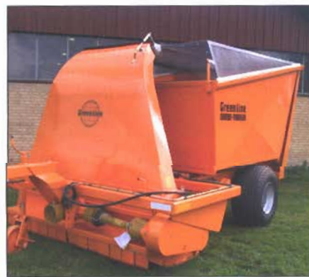
Combi-Trailer – Volume: 6,0 m 3 . Largeur de coupe: 2,10 m. Hauteur au sommet: 2,30 m.
