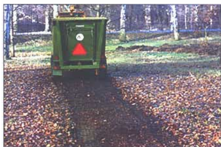
Ramassage de feuilles mortes. Les lames rapprochées assurent une coupe fine des feuilles mortes et des petites branches. Volume: 2,5 m 3 . Hauteur au sommet : 1,75 m.
