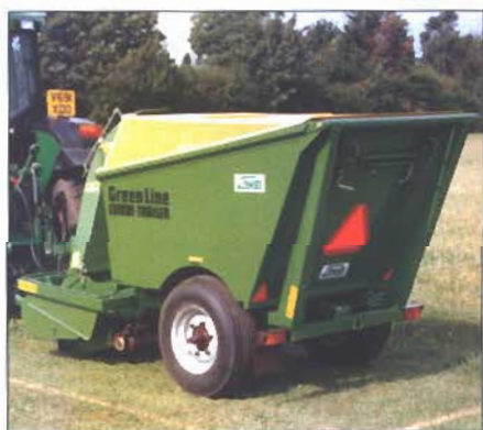
Combi-Trailer – Volume: 2,5 m 3 . Largeur de coupe: 1,30 m. Hauteur au sommet: 1,75 m.
