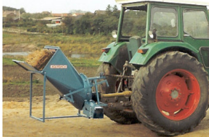
TV - projection vertical - TL avec projection au sol pour tracteur no. 350042-350045. TDU avec plateforme pour distribution de paille entre deux plates-bande de fraiseurs à la fois - Item no. 350052
