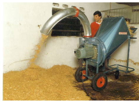
AM 35 BV – projection verticale pour porcheries, logettes, etc. ø160mm tuyaux – pivotons de 360° no. 350028-350029-350031-350032
