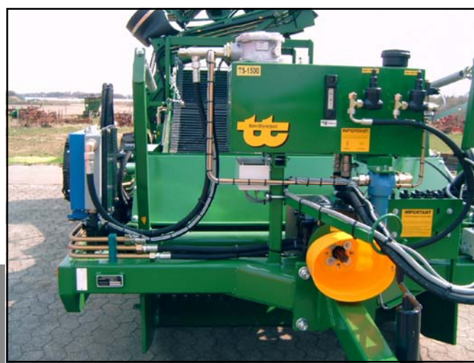
Refroidisseur d'huile (radiateur) pour travail en pleine canicule.
