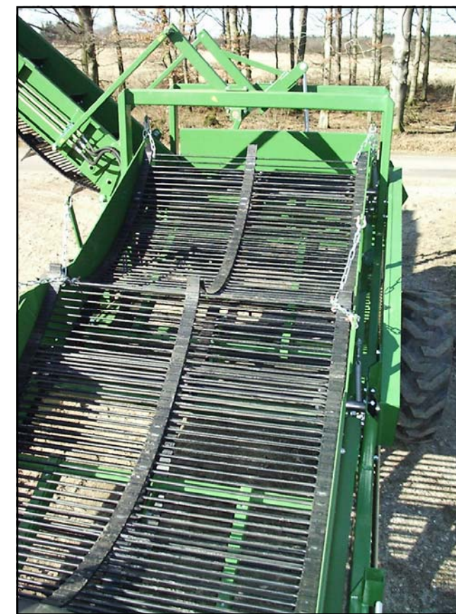
Vérin et manivelle de réglage de profondeur de ramassage (de 0 à 200 mm). Barre de verrouillage de hauteur du rotor d'amenée des pierres en position transport.
