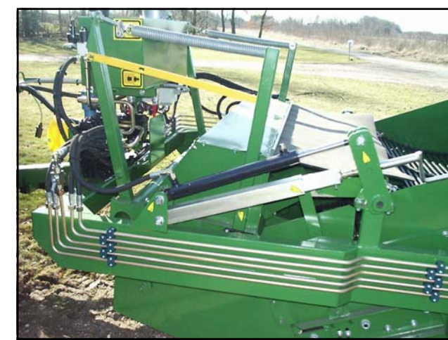
Vérin et manivelle de réglage de profondeur de ramassage (de 0 à 200 mm). Barre de verrouillage de hauteur du rotor d'amenée des pierres en position transport.
