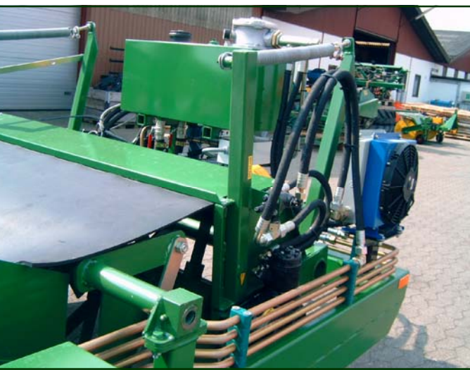
Refroidisseur d'huile (radiateur) pour travail en pleine canicule.
